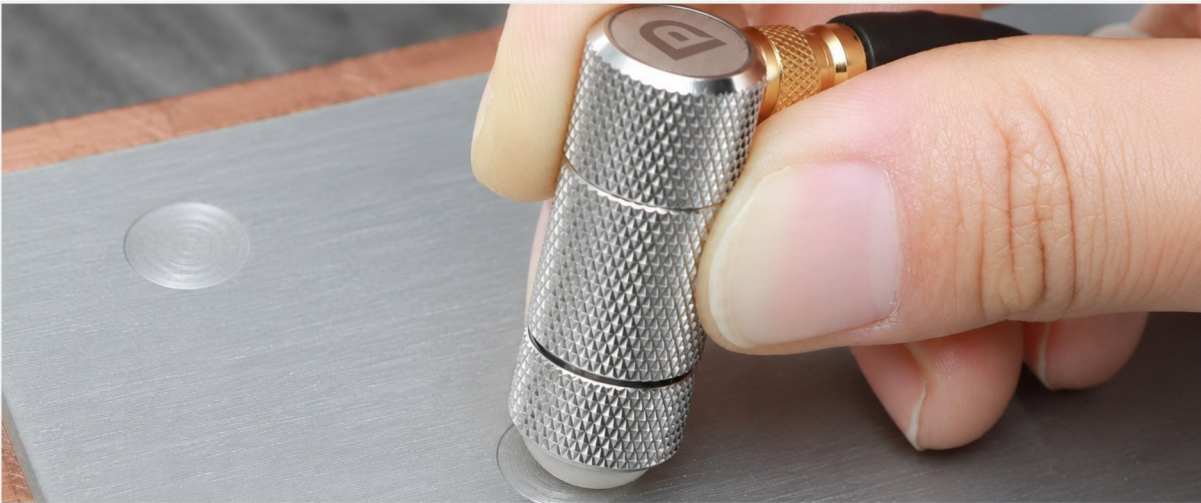
Głowica jednoprzetwornikowa sprzęgana z elementem przez słup wody.
